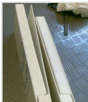
Raggiunto il carico ultimo, che ha causato la rottura a taglio del core, le pelli hanno completamente delaminato separandosi nettamente dal pannello in PET.
