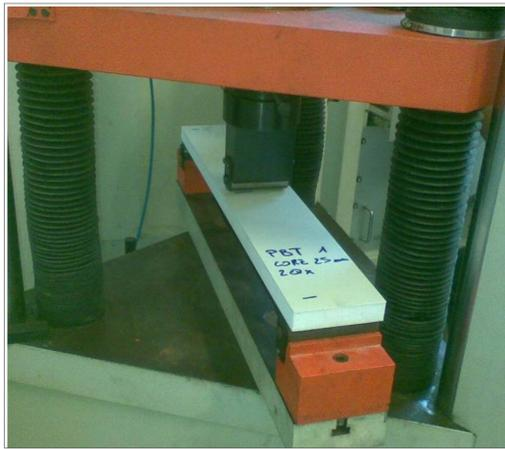
Prova a flessione con carico concentrato in mezzzeria di pannelli sandwich di larghezza 12 cm ed appoggi a 70 cm di interasse.
