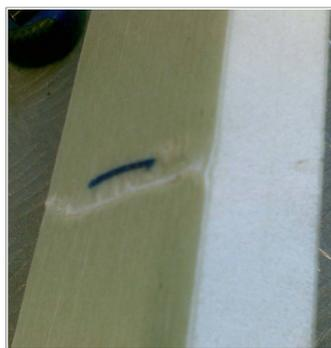
Raggiunto il carico ultimo, che ha causato la rottura a taglio del core, le pelli sono rimaste perfettamente incollate al pannello in PET.
